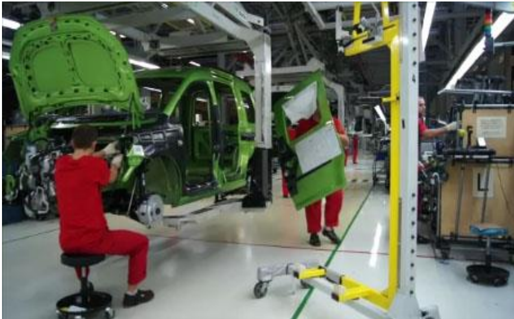
Rysunek 6 Przenoszenie elementów konstrukcyjnych na dziale montażu
