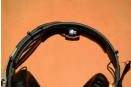
Ryc. 1. Nadajnik wi- bracyjny na listwie łączącej słuchawki
